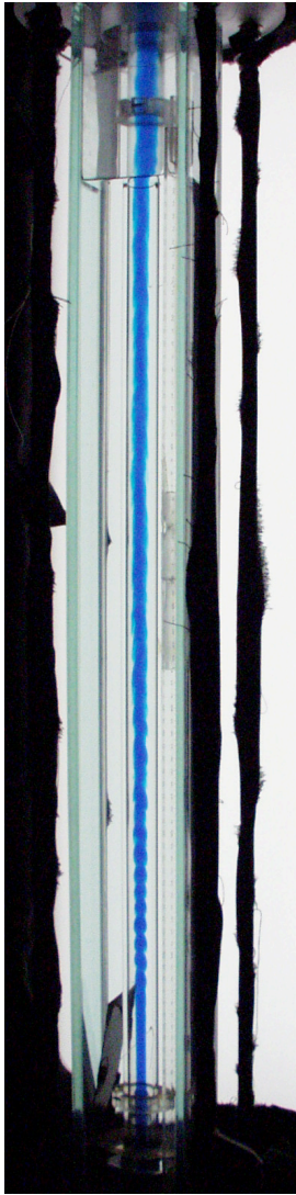
FIG. 2.1 – A gauche, photo du tube expérimental. A droite, schéma de l'injection : l'expérience est alimentée en fluide de coeur (en bleu) par un injecteur emmanché (en vert) dans le tube (en rouge), et en fluide annulaire par des petits trous circulaires percés entre un réservoir et le tube. Le contact entre les deux fluides a lieu au bout de l'injecteur (en vert). L'injecteur a une extrémité biseautée vers le haut. Le rayon intérieur de l'injection r_0 est de 0.75 \text{ cm} , son rayon extérieur de 0.85 \text{ cm} . Sur le schéma de droite, toutes les dimensions sont à l'échelle.
