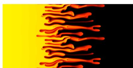
Digitation visqueuse en milieu poreux homogène
