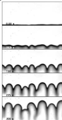
Instabilité de Rayleigh Taylor sur front de réaction chimique auto-catalytique
