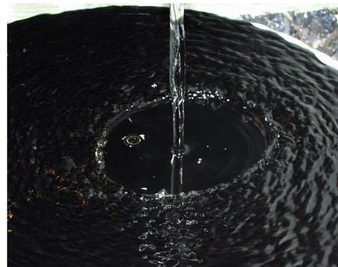
FIGURE 2.21 – Un ressaut hydraulique circulaire tel qu'on peut l'observer au fond d'un évier à fond plat. Un cercle limite une zone centrale mince et lisse d'une zone externe plus épaisse et agitée.
