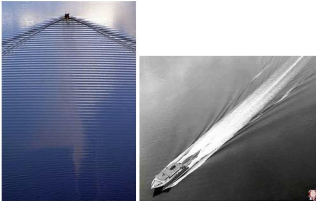
FIGURE 2.12 – Différence des formes de sillage entre (a) un petit bateau de pêche proche de sa vitesse limite de coque (nombre de Froude de l'ordre de 0.5) et (b) un navire très rapide (nombre de Froude grand devant 1).
