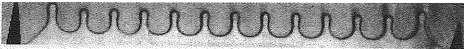
Figure 11 : Photographie de l'interface dans la géométrie plan/cylindre lorsque l'interface est "accrochée" aux deux bouts par des pointes (en noir).
