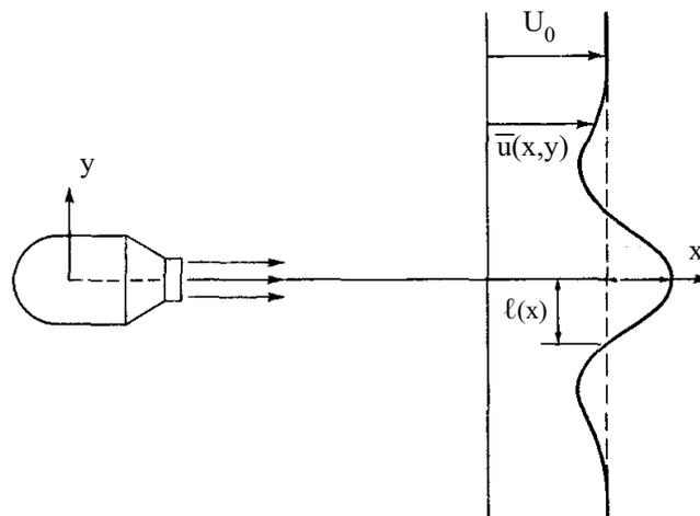
FIGURE 1 – Sillage bi-dimensionnel d'un objet propulsé montrant un profil de la vitesse moyenne  $\bar{u}$  non monotone en aval de l'objet.
