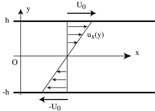
Figure 2: Géométrie de l'écoulement de Couette plan, et profil de vitesse correspondant dans le cas laminaire.
