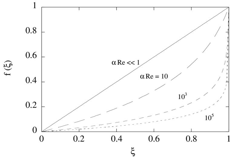
Figure 3: Profils de vitesse adimensionnés (5) pour différentes valeurs de  $\alpha Re$ .
