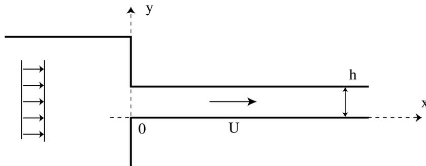
Figure 1: Conduite parallélépipédique en sortie d'une chambre de tranquillisation
