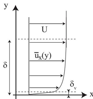
Figure 1: Schéma d'une couche limite turbulente.
