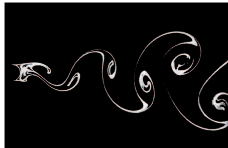
Figure 2: Allée tourbillonnaire de von Karman dans l'écoulement en aval d'un cylindre (l'écoulement va de gauche à droite).
