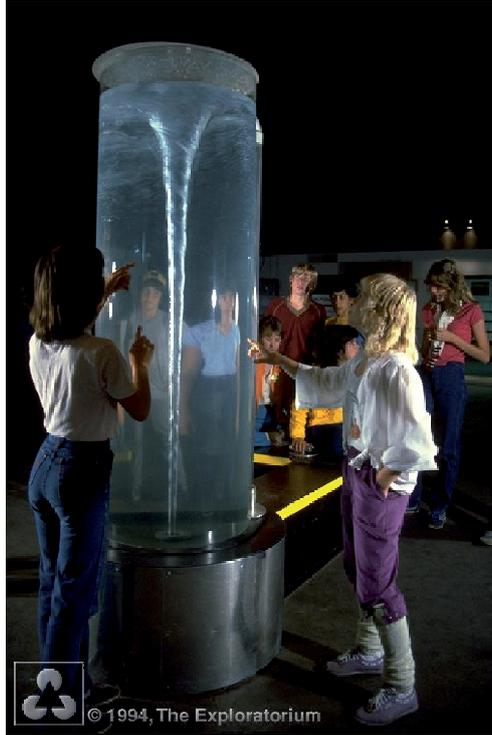
FIGURE 1 – Démonstration du mécanisme d'étirement tourbillonnaire.
