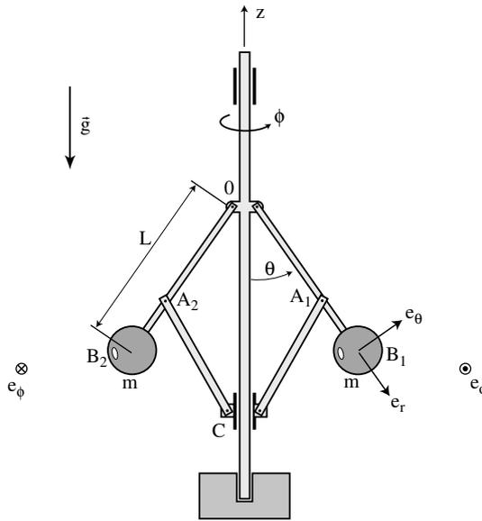
Figure 2: Modèle simplifié de régulateur de Watt.
