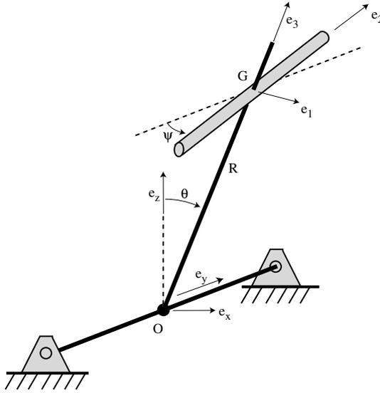
Figure 3: Une hélice montée sur un pivot.
