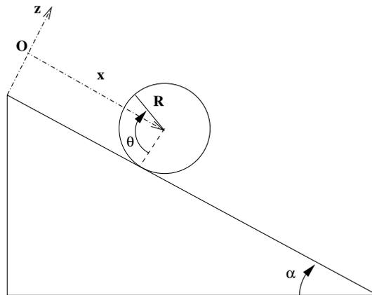
Figure 1: Cerceau roulant sans glisser sur un plan incliné.
