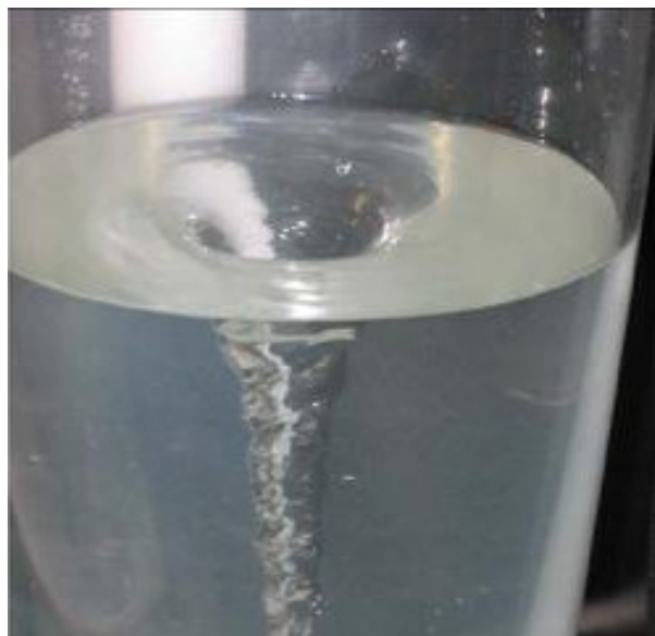
Figure 1: Prise de vue du réservoir et du cœur de tourbillon de vidange, en son centre.
