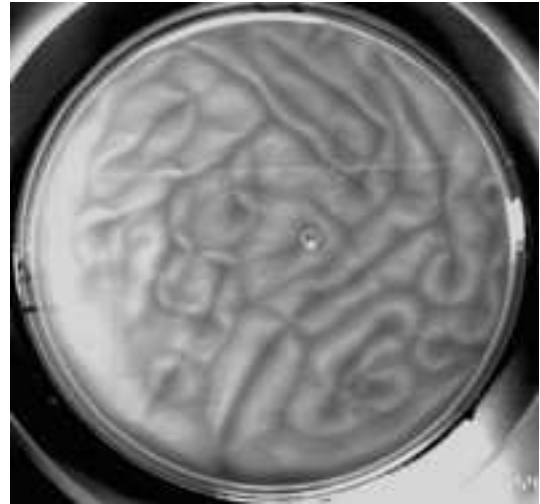
Fig. 1 – Cinétiques de séchage et cellules convectives pour deux expériences d'épaisseurs initiales 4mm (exp1, colonne de gauche) et 8.7mm (exp2, colonne de droite). Les photos ont été prises respectivement 37s (exp1) et 174s (exp2) après le versement de la solution
