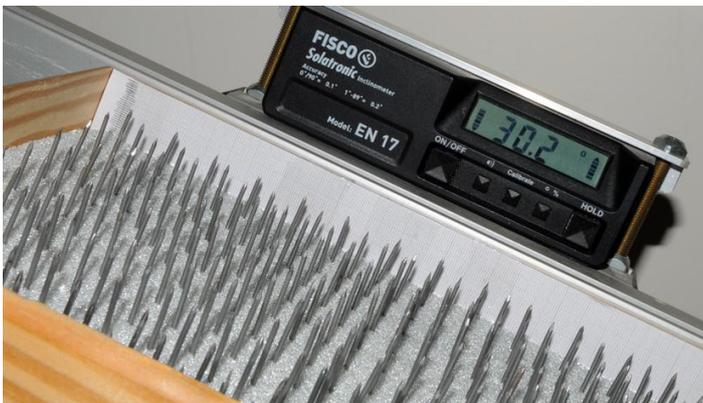
**Fig. :** Écoulement de grains le long d'un plan incliné parsemé d'obstacles.
