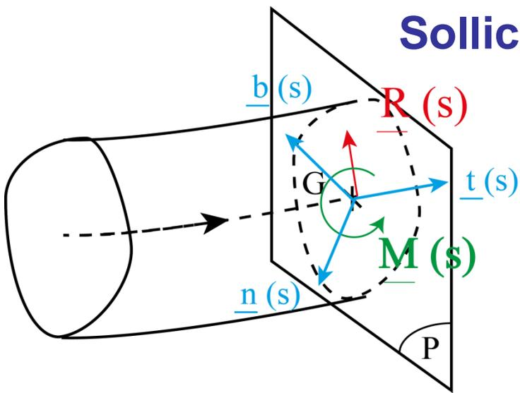
Le plan (P) contient la section de la poutre et les vecteurs de bases  $\underline{n}(s)$  et  $\underline{b}(s)$ .
