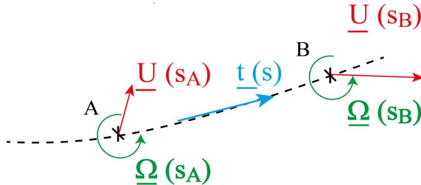
$$\underline{\Omega}(s_B) = \int_{s_A}^{s_B} \underline{\chi}(s) ds + \underline{\Omega}(s_A)$$
